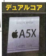
↑A5XはA5と同じデュアルコアCPUだが、クアッドコアGPUを新たに搭載する。
