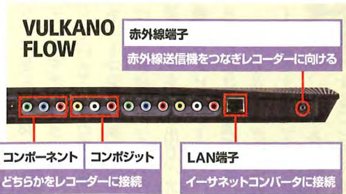
図20 コンポーネントコンボジット端子とレコーダーのAV出力端子をケーブルで接続。赤外線端子には付属の赤外線送信機を接続して、レコーダーのリモコン受信部に向ける
