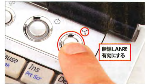
図2 ノートパソコンには、無線LANのスイッチがある。無線設定がうまくできない理由の多くが、このスイッチがオフになっていることだ。必ずオンにしておく
