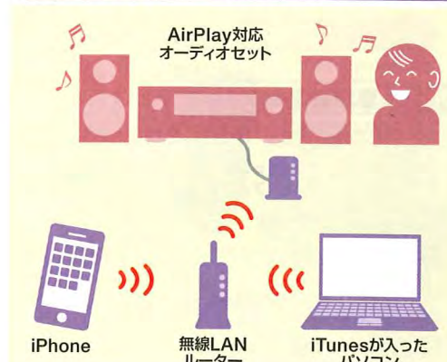
図28 AirPlay対応のアンプを使えば、iTunesで管理しているパソコン内の曲をWi-Fiでオーディオ機器に送信して、再生できる。オーディオ機器はイーサネットコンバーターで無線化
