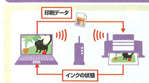
図3 Wi-Fi対応プリンター(複合機)なら、USB接続時と同じように利用可能。インクの残量を確認したり、複合機のスキナー機能も使ったりできる
