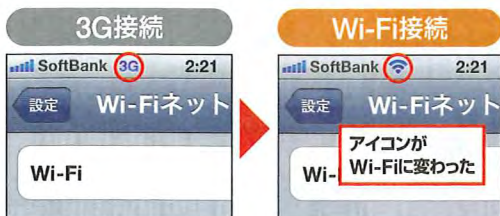
図9 図8で暗号キーを入力後、「Join」をタップすると認証作業が実行される。無事認証されると、iPhone上の接続先アイコンが「3G」からWi-Fiアイコンに変わる
