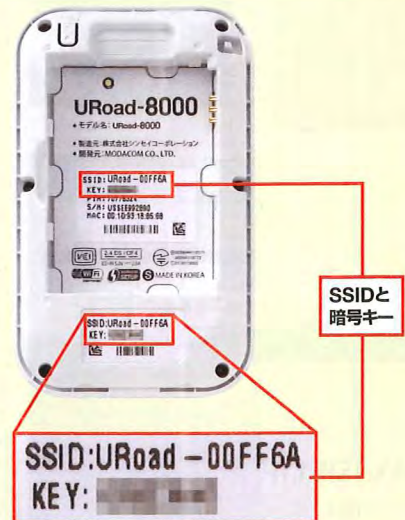
図13 裏フタを開けたところ。バッテリーを取り外さなくても、バッテリーの下側に「SSID」と「暗号キー」が確認できる。さらにバッテリーを外した下にも書かれている
