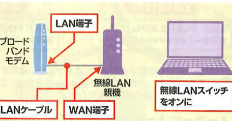
図8 まずは、製品に付属するLANケーブルを使って、ブロードバンドモデムと親機を接続する。つなげるのは、ADSLや光回線のモデムのLAN端子と無線LAN親機のWAN端子だ
