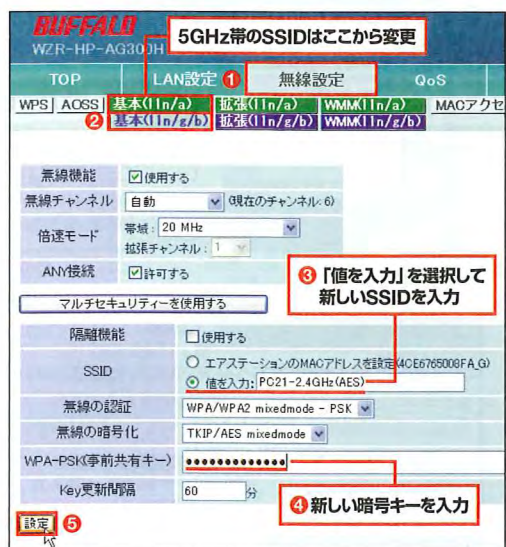
図18 「基本(11n/g/b)」の設定画面を開いたら(1)(2)、「SSID」欄と「WPA-PSK(事前共有キー)」欄を新しいSSIDと暗号キーに書き換えて(3)(4)、「設定」を押す(5)
