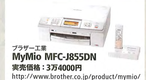
図24 ブラザー工業の複合機「MFC-J855DN」なら、ファクスで使う電話線を無線化できる。電話線は「通信ボックス」をつなぎ、複合機本体とは無線でやり取りする
