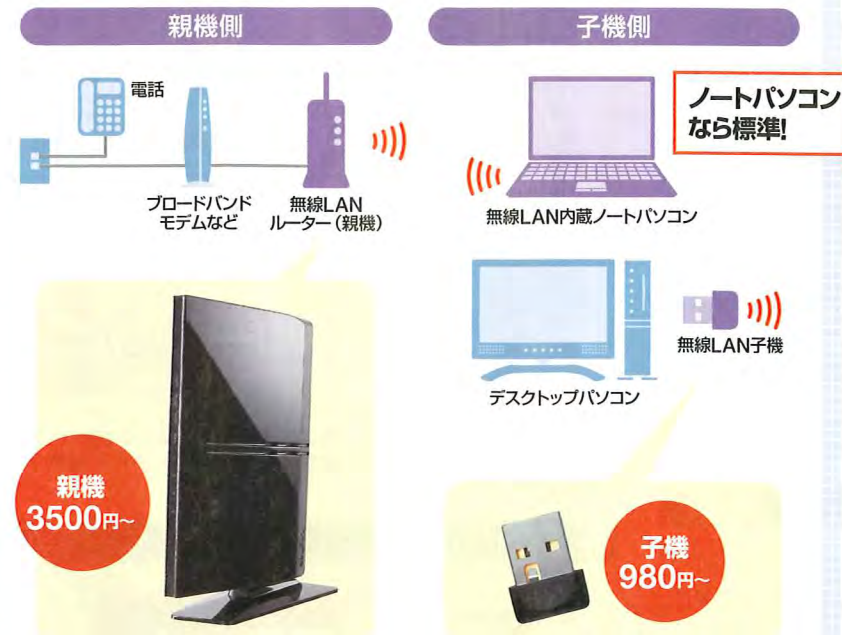
図1 パソコンの無線化に必要なのは、親機(無線LANルーター)と子機だけ。多くのノートパソコンには子機が内蔵されているので、親機の追加だけでよい。最近では、わずか3500円程度で十分な性能の親機が購入できる。親機は、ブロードバンドモデムなどに接続して利用する
