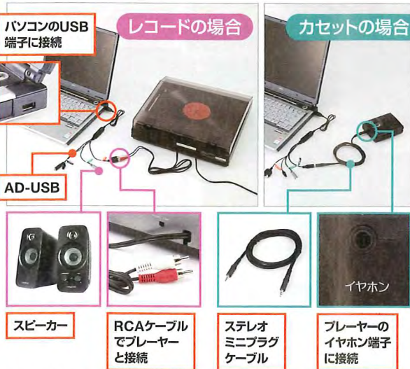
図3 AD-USBの接続方法。まずはパソコンのUSB端子に接続。次にRCAケーブルまたはステレオミニプラグケーブルで、レコードやカセットテープのプレーヤーとつなぐ。さらにスピーカーをつなげば完了だ
