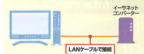
図19 次はイーサネットコンバーターの設定だ。LANケーブルでイーサネットコンバーターをパソコンと接続する
